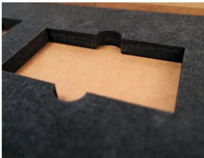
Nous proposons un service de découpe laser sur mesure dans différentes densités de mousse pour le garnissage d'emballages carton ou coffrets en bois.
